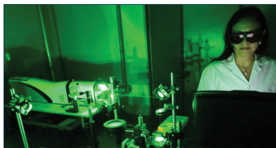
[FIGURA 1] Estrutura laboratorial da Embrapa, utilizando laser, para gerar medidas com método inovador LIBS para detecção de C em amostras de solos.
